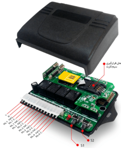
شکل 2 - نحوه جایگذاری سیم کارت
