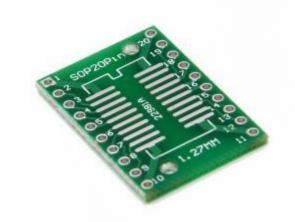
TSSOP20 SSOP20 SOP20 SMD to DIP20 IC Adapter Converter Socket Board Module Adapters Plate 0.65mm 1.27mm Integrate
