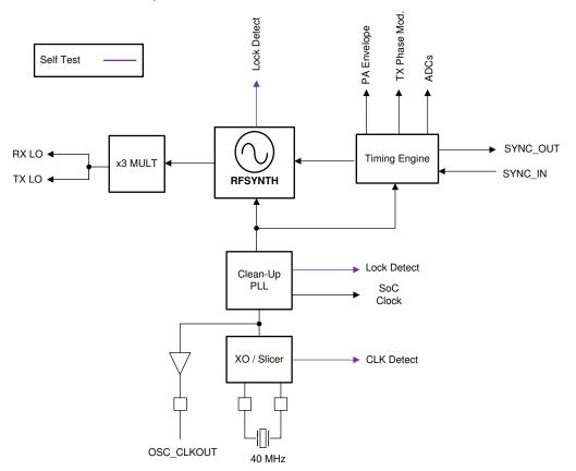
Figure 8-2. Clock Subsystem
